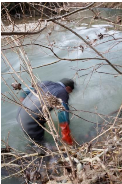
Photo 21 : Pose dans le cours d'eau (station ARG06) d'un thermographe enregistreur
