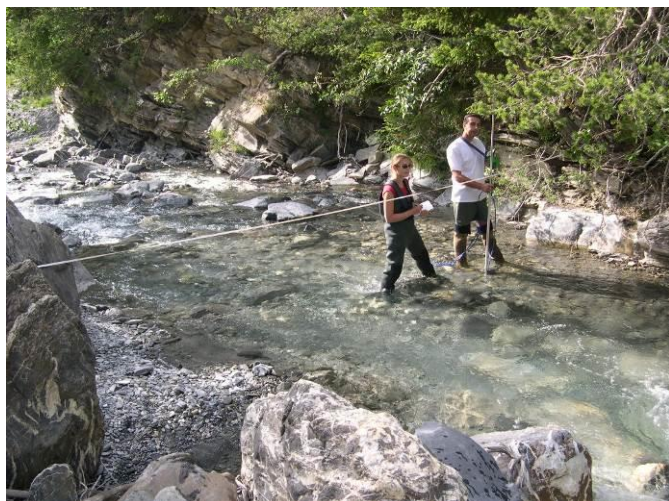
Photo 18 : Jaugeage à l'aide d'un courantomètre
