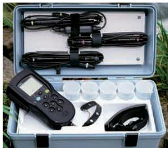
Photo 19 : Sonde multi-paramètres utilisées pour les mesures in situ
