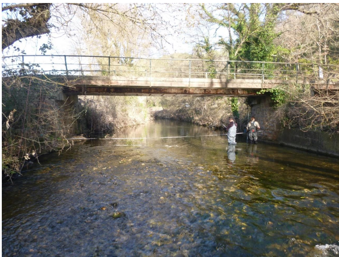
Photo 35 : jaugeage à la station 04 sur la source de l'eau
