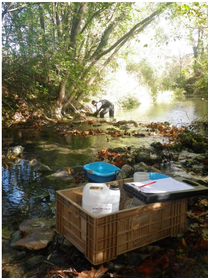
Photos 39 : Prélèvements IBGN DCE à l'aide du filet Surber sur la station 02 sur le Cauron
