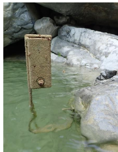
Photo 9 : Thermographe du Riou de Pierrefeu retrouvé exondé à la suite de la torsion de l'arrimage en septembre 2021.
