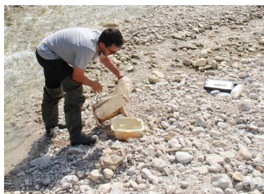
Photo 2 : Prélèvements quantitatifs à l'aide du filet Surber.
