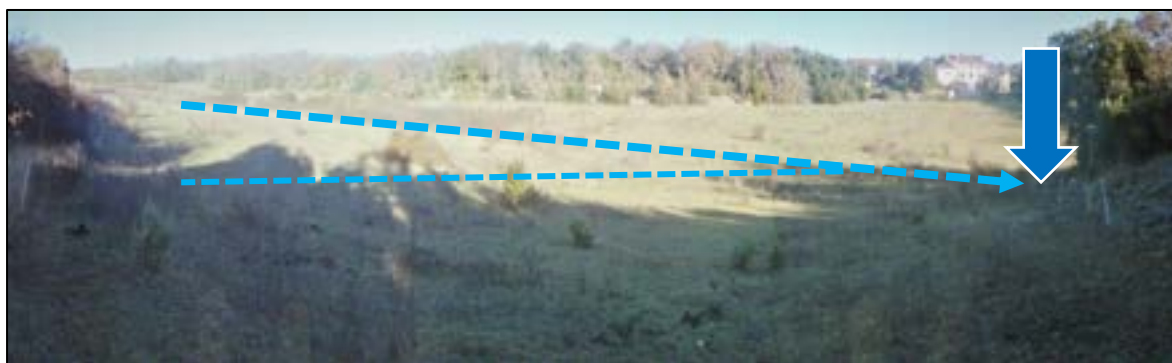
VUE D'ENSEMBLE DE L'IMPLUVIUM ET TRACE SUPPOSE DES DRAINS (EN BLEU) ET POSITIONNEMENT DE LA CITERNE (INDIQUE PAR LA FLECHE VERTICALE) (PHOTO MRE)
