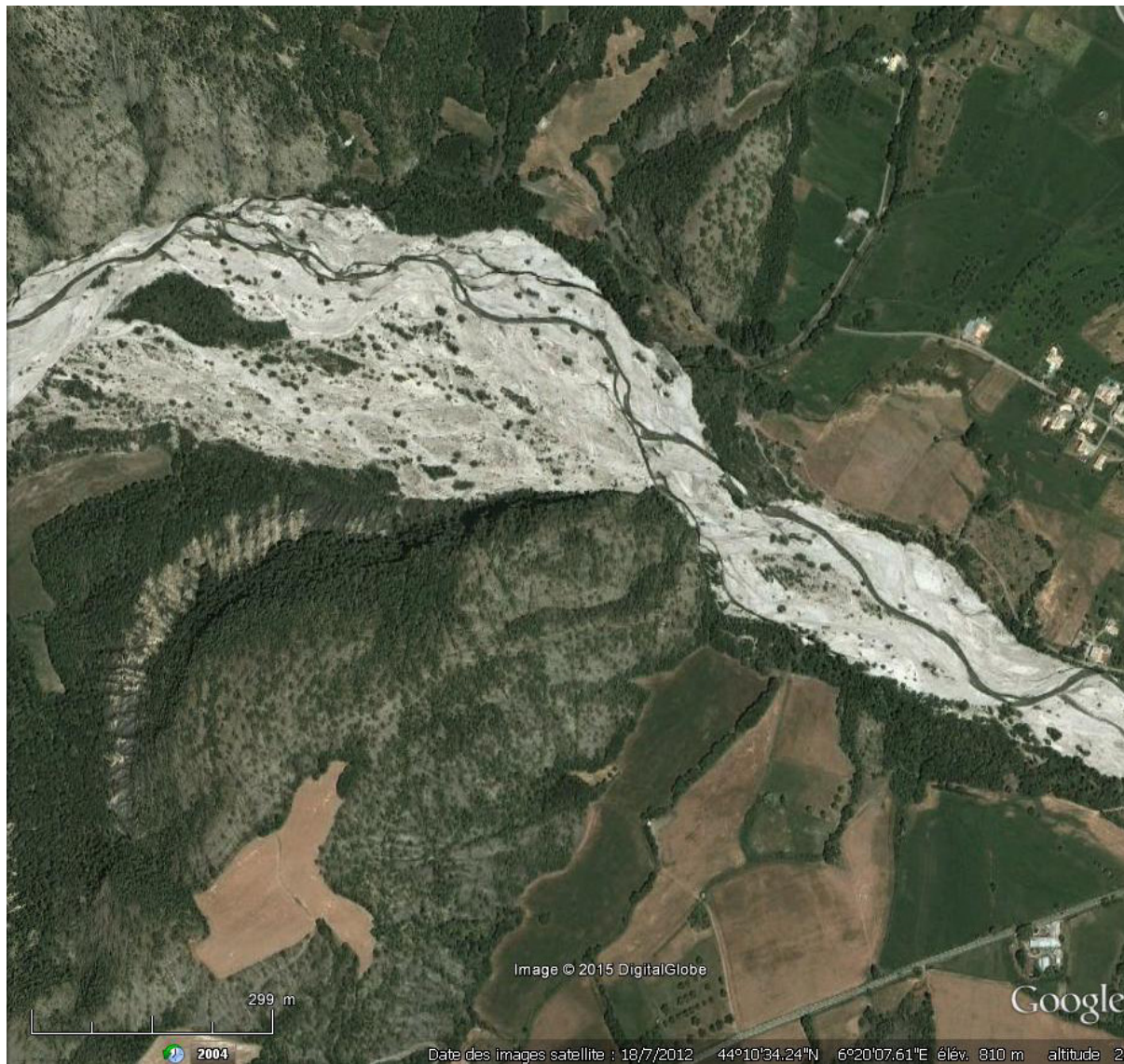
Figure 33 : exemple de structure en perles d'un lit en tresses : la Bléone à La Javie (Google Earth)
