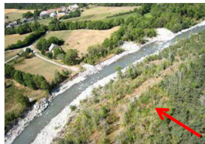
Figure 55 : incision du lit (à gauche) et dépérissement de la forêt alluviale (à droite)
